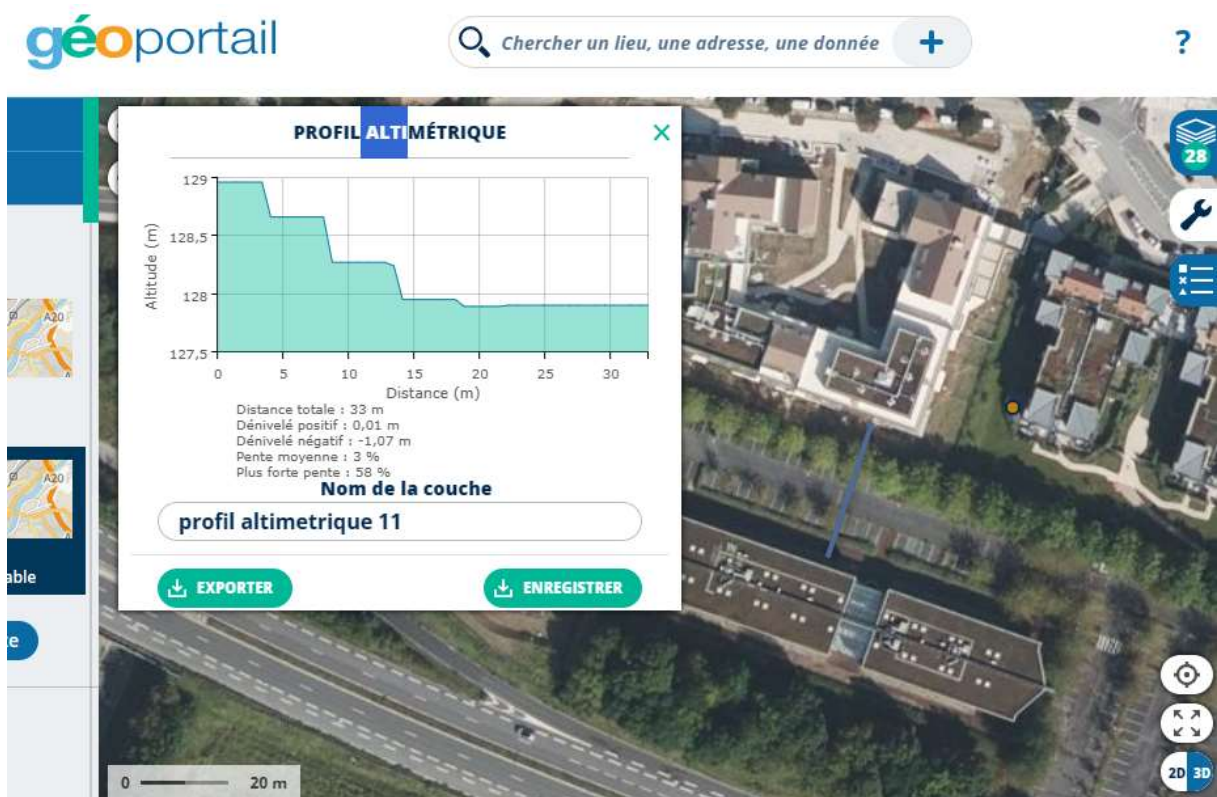
Figure 6: 1 m de dénivelée entre le Clos du Roy et le centre de la parcelle
